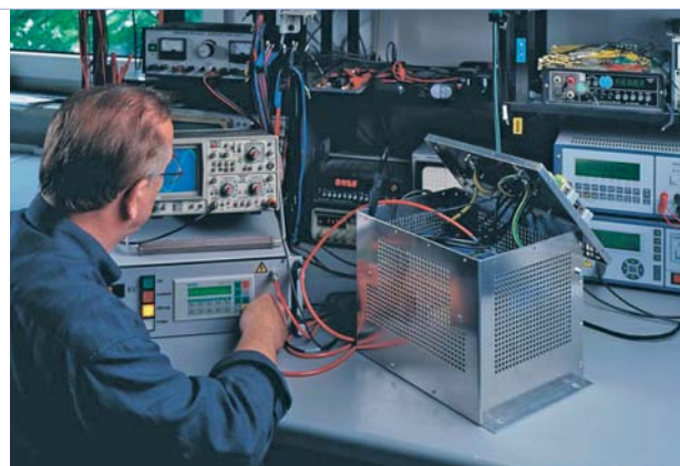
Test van een maatwerk EMC-filter in het laboratorium van Fuss.
