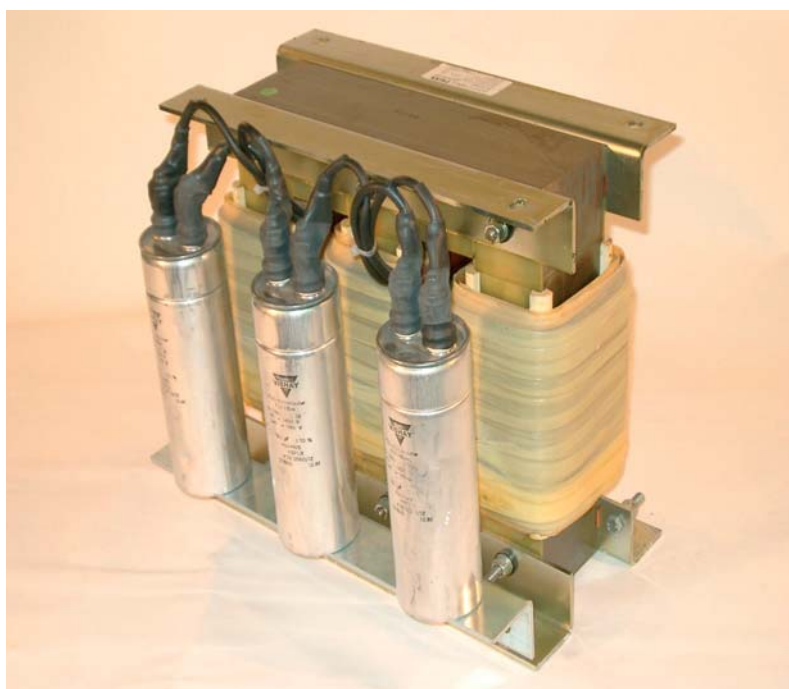
Dit 100-A sinusfilter maakt weer een sinusvormig signaal van de blokvormige afzonderlijke stromen in de drie fasen achter de frequentieregelaar.
