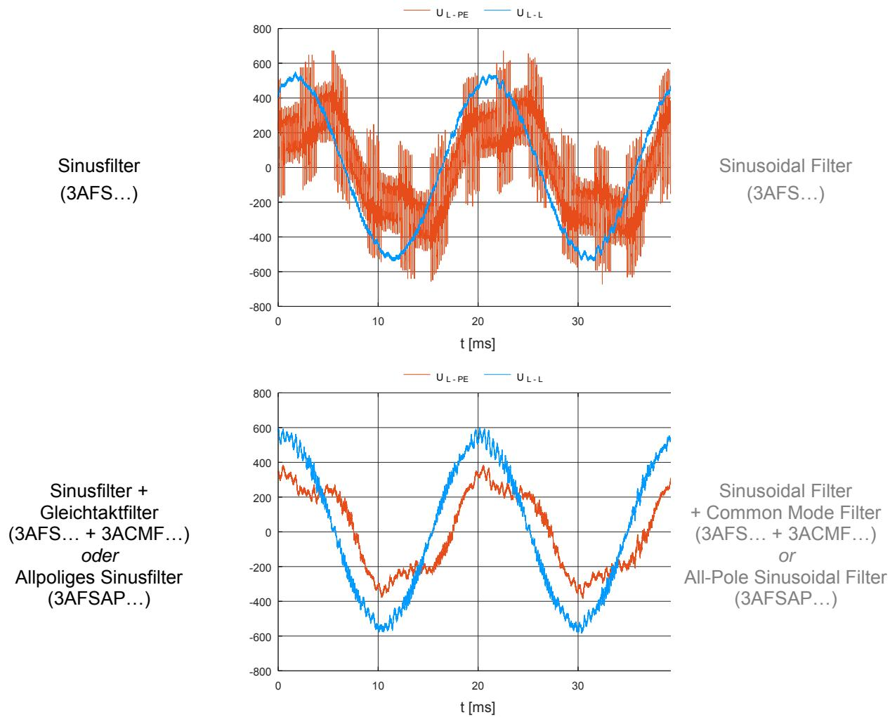
Mit allpoligen Sinusfiltern sind am Ausgang von Frequenzumrichtern keine geschirmten Kabel mehr erforderlich.
