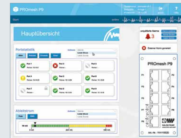
Afbeelding 3. Netwerkbelasting of EMC? De switches PROMesh P9 en PROMesh P20 van Indu-Sol tonen de diagnosegegevens van mogelijke oorzaken van gebeurtenissen in één oogopslag en maken zo een gericht oorzaakonderzoek mogelijk, zelfs bij onderhoud op afstand.
